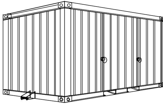
**mit Absetzvorrichtung nach DIN 30720**
